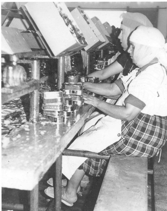
Abb. 36. Die gekochten Sardinen werden in Büchsen verpackt, Verarbeitungsbetrieb in Safi, Marokko. (Aufn. E. D o n n e r)
