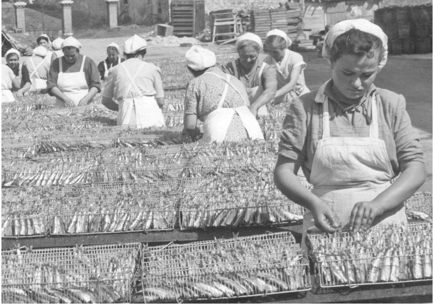
Abb. 35. Sardinenverarbeitungsbetrieb in Jugoslawien. Einsortieren der vorbehandelten Sardinen in Drahtkörbe, die im anschließenden Arbeitsgang in die Kochvorrichtung eingeschoben werden. Im Gegensatz zu den Praktiken westeuropäischer und nordwestafrikanischer Betriebe werden die Schwanzflossen der zu verarbeitenden Sardinen in Jugoslawien nicht entfernt. (Nach FAO-Photo V e s t e r h u s , aus R i e d e l , in F. P a x , 1962)
